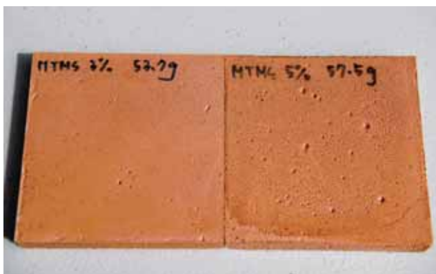
圖 4 氣凝膠酚醛發泡複合板，其產品耐燃性能從耐燃二級增進為耐燃一級
