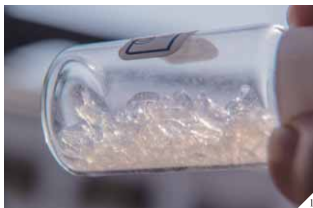
圖 1 氣凝膠，也稱作空氣膠或稀密封，具有良好的隔熱能力
