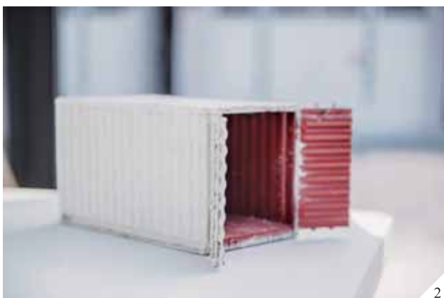
圖 2 添加氣凝膠與相變化材料之隔熱塗料結合防水水泥砂噴灑於鐵皮
