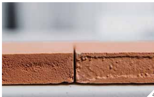
圖 4 氣凝膠酚醛發泡複合板，其產品耐燃性能從耐燃二級增進為耐燃一級
