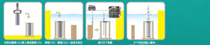
空密封鋼筒(TSC)置入專設運輸(TPH) 運輸(TPH)-鋼筒(TSC)一起進淨化池 進行水下裝載 水下空殼浮吊上車後，運輸(TPH)與鋼筒(TSC)一起搬出
