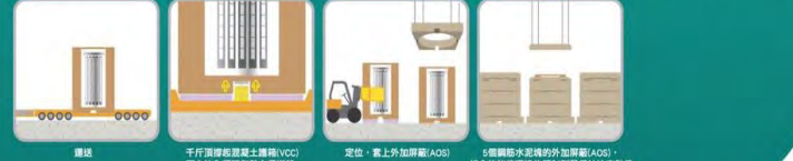
運貯 千斤頂將裝載土牆箱(VCC)下方放入懸浮氣墊方便搬移 定位，裝上外加屏蔽(AOS) 6噸鋼架水不濕的外加屏蔽(AOS)，組合後能使環境的輻射劑量低於法定數值
