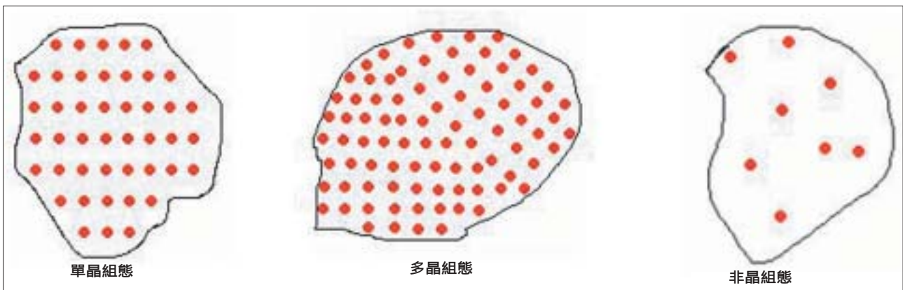
原子排列的結構可以區分成單晶組態、多晶組態和非晶組態。
